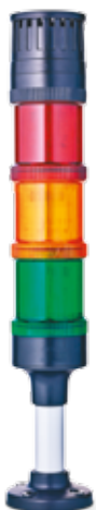
Número de artículo: ECO60-Q31 Colores: rojo-naranja-verde Función: Indicador LED luz fija, zumbador con tono continuo o de pulso Tensión nominal: 24 V CA/CC Tipo de montaje: Montaje de tubos (tubo de 100 mm de longitud)
