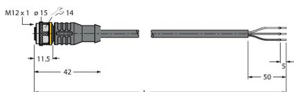
Cable de conexión, conector hembra M12, recto, 3 polos, longitud de cable: 2m, material de la funda: PVC, negro; homologación cULus; disponibles otras longitudes de cable y variantes, véase [www.turck.com](http://www.turck.com)
